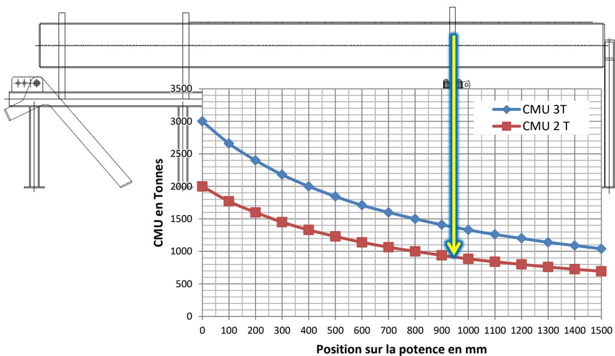
Exemple dans ce cas : CMU engin de levage 2T à 800mm du tablier, 900Kg de CMU à 950mm de la potence.
