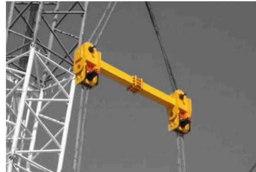
Les **écarteurs** sont utilisés pour écarter et soulever des **charges lourdes et volumineuses**. Ils sont composés d'une ou plusieurs poutres en forme de cadre.
