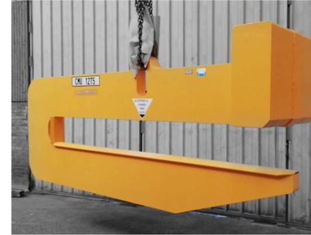
Les **cés** sont des équipements en forme de «C» dont le bras inférieur supporte la charge, relié au bras supérieur par un montant vertical et permettent la manutention de **charges creuses** (simple ou double) comme des rouleaux, des tuyaux, des bobines. Les cés peuvent aussi permettre d'**éviter un obstacle**.
