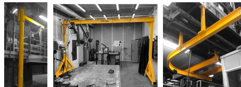
La **potence** permet de soulever et **déplacer des charges dans un rayon d'action précis et restreint**. Elle peut être pivotante. La charge est déplacée le long de la poutre par un moyen de levage (chariot et palan).
