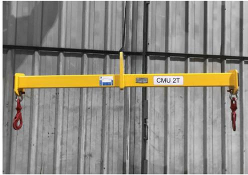
Le **palonnier monopoutre** se compose d'une poutre principale qui possède différents points de levage inférieurs. Il permet de lever des **charges linéaires** en toute sécurité.
