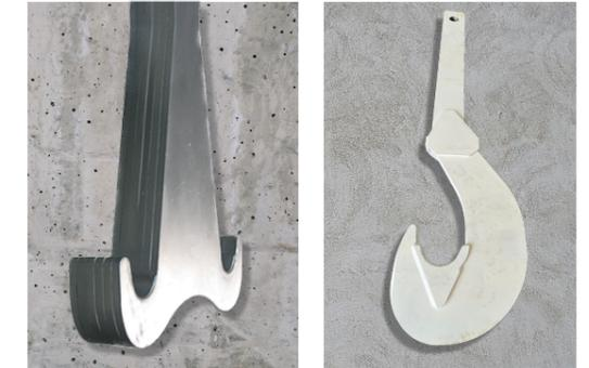
Les **crochets lamellaires** sont composés de plusieurs **tôles rivetées à chaud**. Permettant de manutentionner des **charges lourdes** (ex : poches de coulées).
