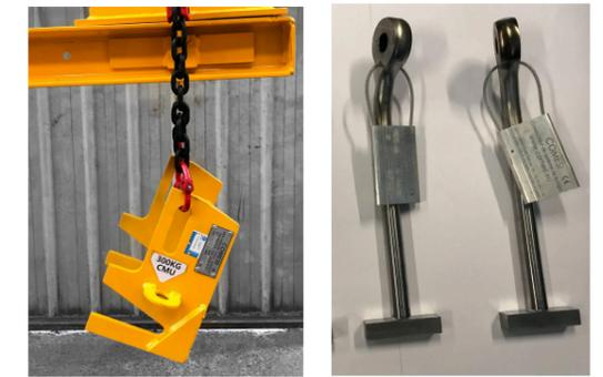
Un **agrès** est une pièce permettant le **levage de pièces spécifiques**, avec un système d'accroche dédié.
